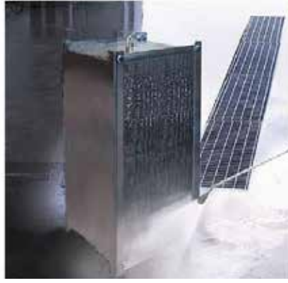
Adım 2: Basıncılı su ile temizlenir.
